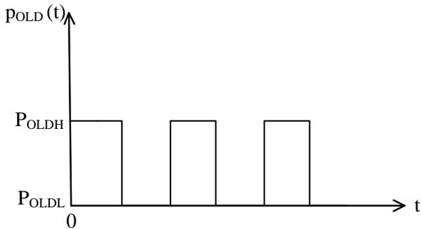
图12、激光二极管光功率  $P_{OLD}$  波形
