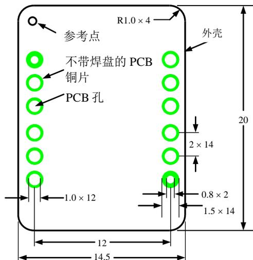
图 18、DIP 封装控制器的 PCB 管脚俯视图
