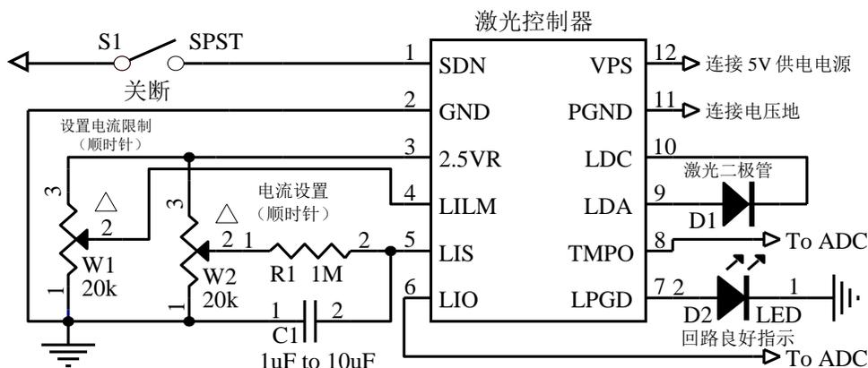
图4.2、ATLS200MA103-PD的典型独立CW应用示意图
