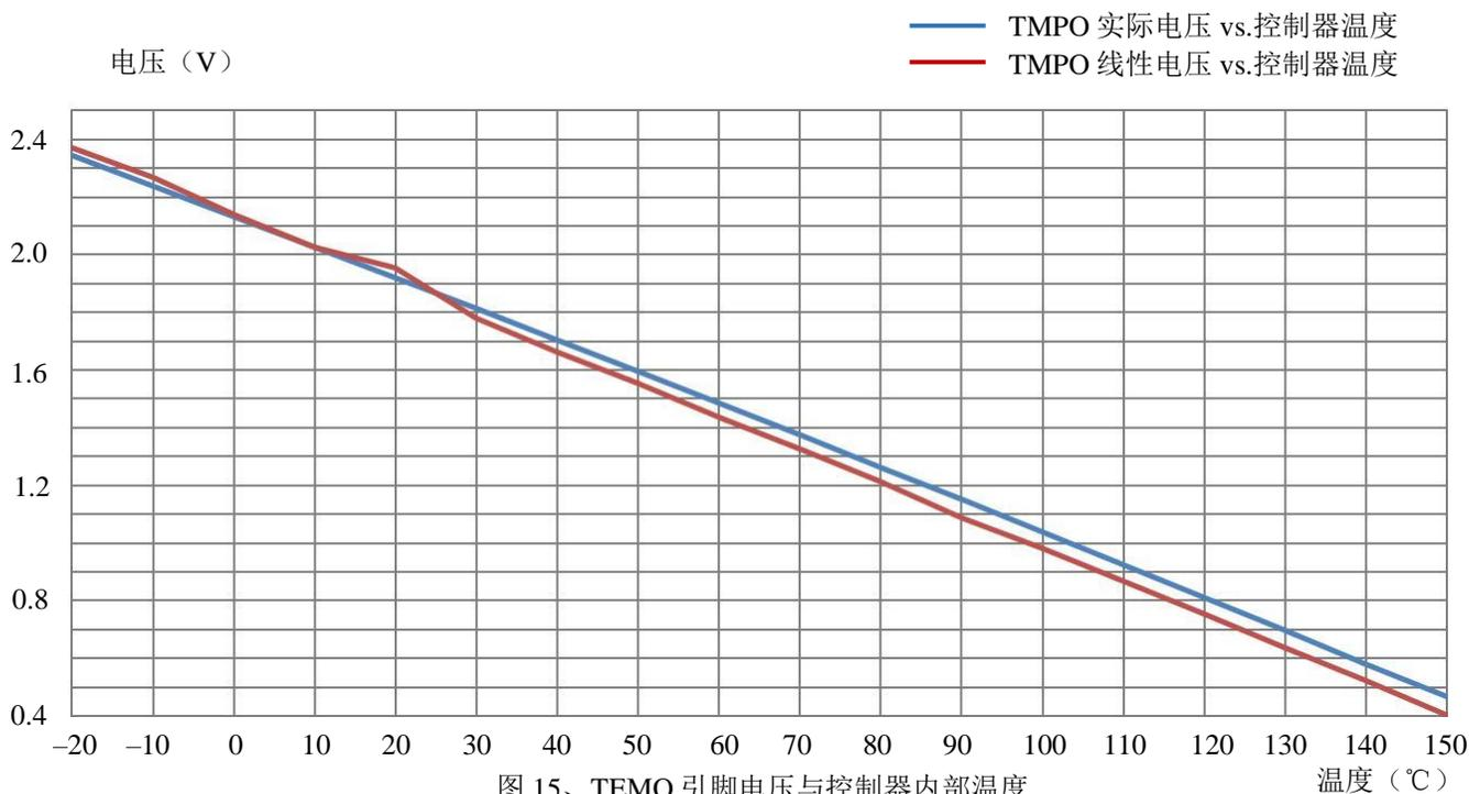
图15、TEM0引脚电压与控制器内部温度
